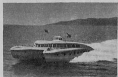
Рис. 1. ДВУХКОРПУСНЫЙ ГЛИССЕР «ЭКСПРЕСС» КОНСТРУКЦИИ ИНЖЕНЕРА В. А. ГАРТВИГА.
